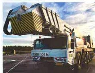
↑ Die britische Niederlassung des dänischen Vermietunternehmens BMS hat eine 103-Meter-LKW-Bühne vom Typ Palfinger/Wumag WT1000 bekommen. Auf einem 5-achsigen Fahrgestell montiert, bietet die WT1000 eine Reichweite von 35 Metern bei einer uneingeschränkten Plattformkapazität von 200 Kilogramm. Die maximale Tragfähigkeit der Plattform beträgt 600 Kilogramm.
