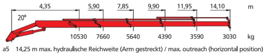
a5 14,25 m max. hydraulische Reichweite (Arm gestreckt) / max. outreach (horizontal position)
